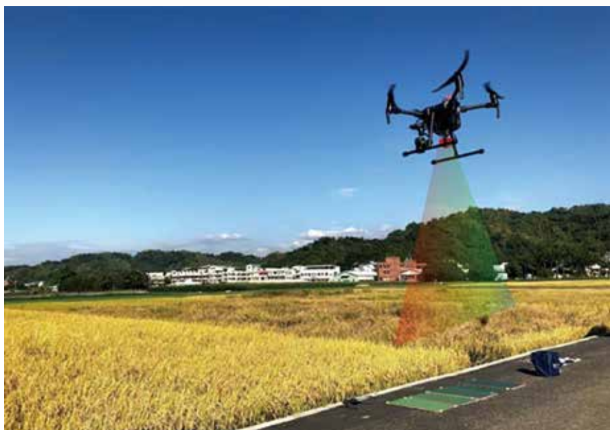
圖三、無人機以多光譜影像收集災損影像示意圖
