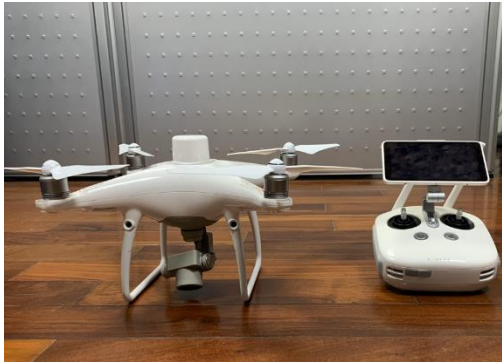
圖 3 Phantom 4 RTK 之空拍機、遙控器與雲台相機外觀。
