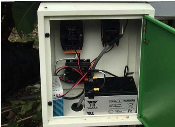
圖 7 GPS 監測站設備箱示意圖。(圖片來源：亞際工程技術顧問有限公司，2017)
