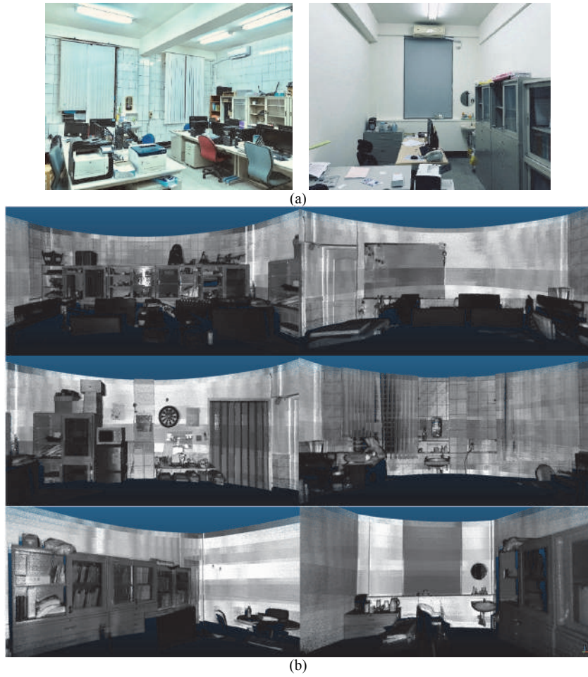
圖 5 AGL 研究室照片與對應之點雲模型 Fig.5 The indoor pictures (a) and point cloud models (b) of the AGL
