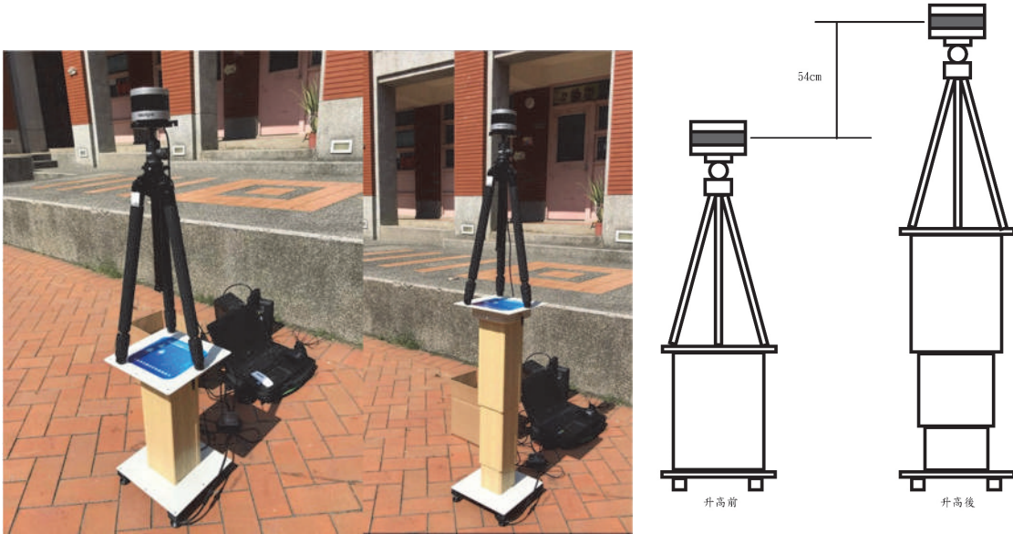
圖 2 VLP-16 結合相機腳架與升降平台之外觀 (左) 與示意圖 (右)
